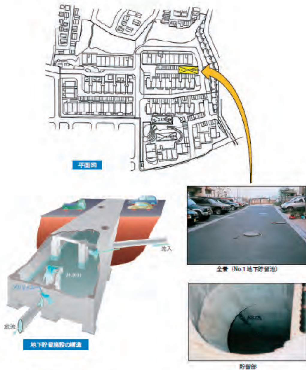
図 6.8-1 集合住宅地への貯留例
