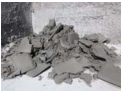
生コン工場から発生する産業廃棄物 生コンスラッジ
