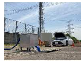
Thử nghiệm sử dụng FCV làm nguồn điện phục vụ trong trường hợp xảy ra thảm họa.
