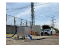
災害時を想定した作業用電源としてのFCV活用実験
