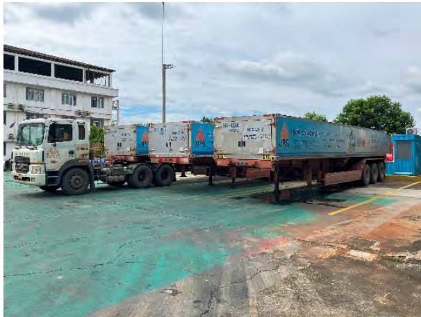
図 2-1 CNG 搬入用のコンテナ
