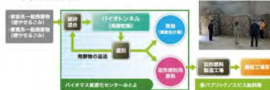
トンネルコンポスト方式の技術概要 (トンネルコンポスト方式) 特 許 (Nicosunnel.net)
