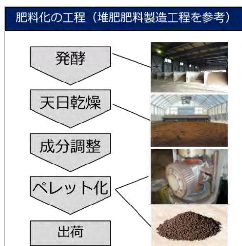
図 2-22 堆肥ペレット肥料の製造工程
