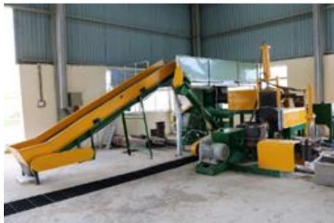
図 91 プラスチック造粒設備
