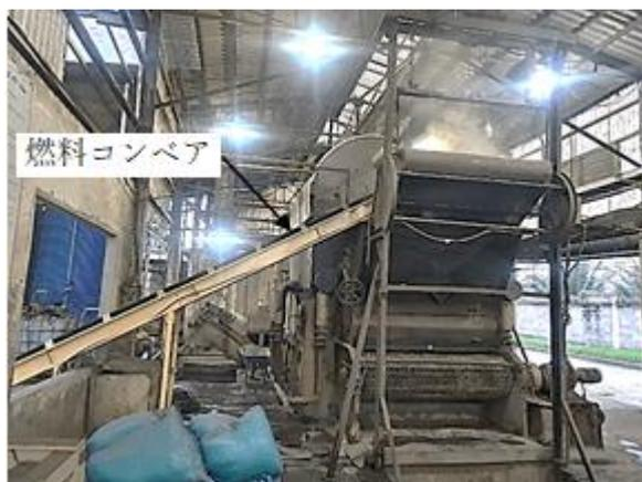
図 75 CJ Agri のベトナムボイラ製自然循環ボイラ（移動床ストーカ焚）
