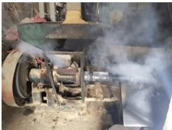
図 23 ブリケット加工装置(上部より籾殻投入)
