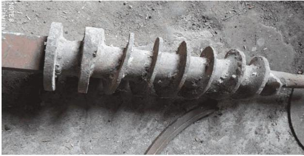
図 27 既存ブリケット加工装置のスクリュー
