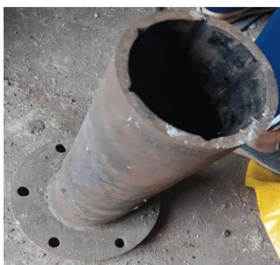
図 24 既存ブリケット加工装置のノズル
