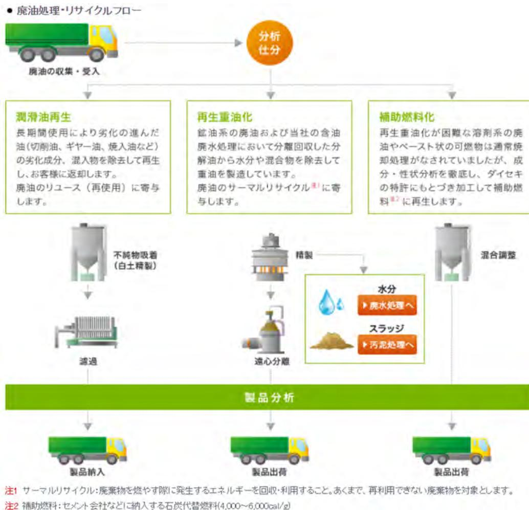
図 2.2.1.3. ダイセキにおける廃油処理・リサイクルのフロー
