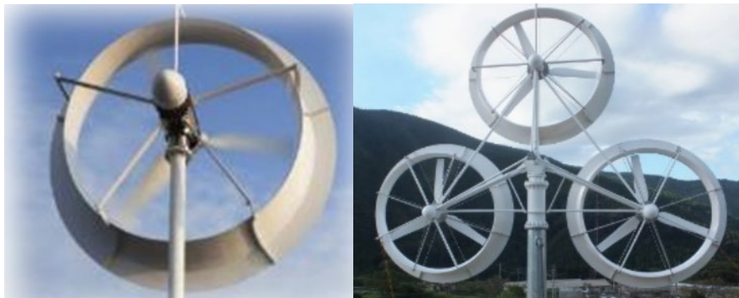
図 4-12 レンズ風車のイメージ（左：シングル、右：3 連マルチ）
