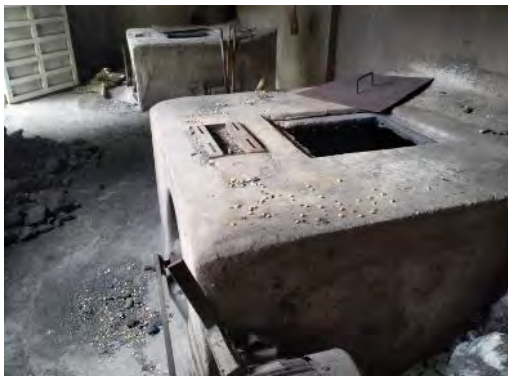
図 33 燃焼炉への石炭投入口（左）、石炭燃焼炉に入れられた石炭（右）
