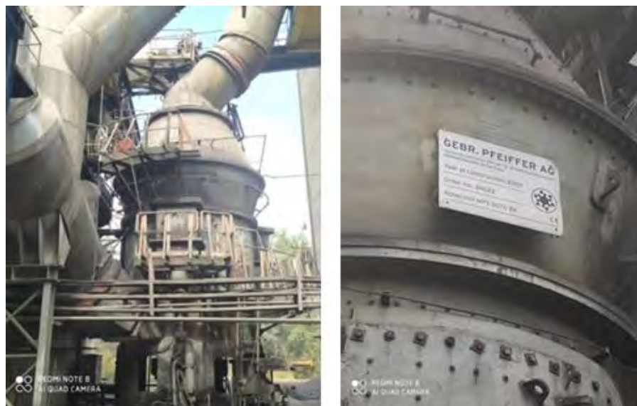
図 30 FICO 社で使用している石炭ミル
