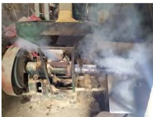
図 20 ブリケット成型部(上から籾殻投入)
