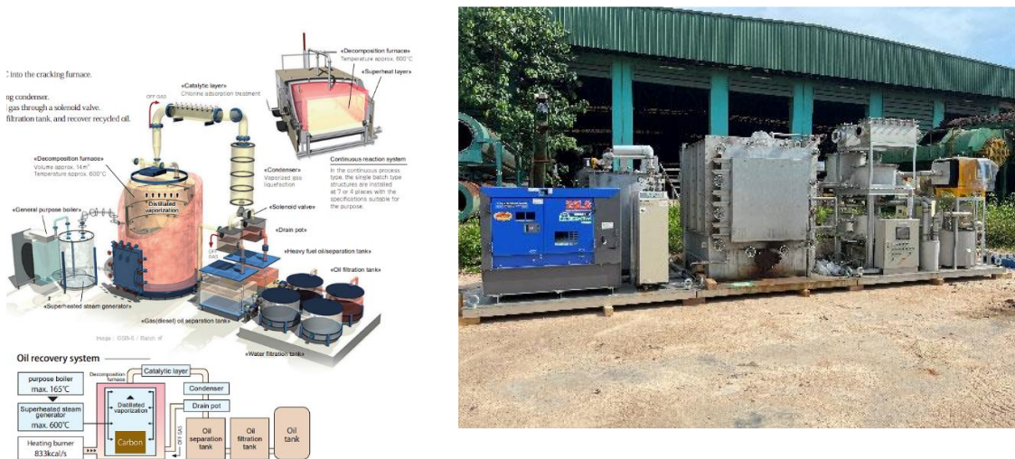
図 4-8. GOMI ソリューションズ社の廃棄物処理装置
