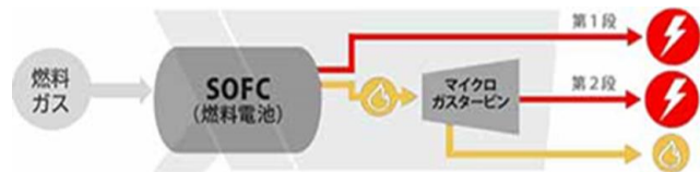
図3.10 SOFCの発電等の仕組み
