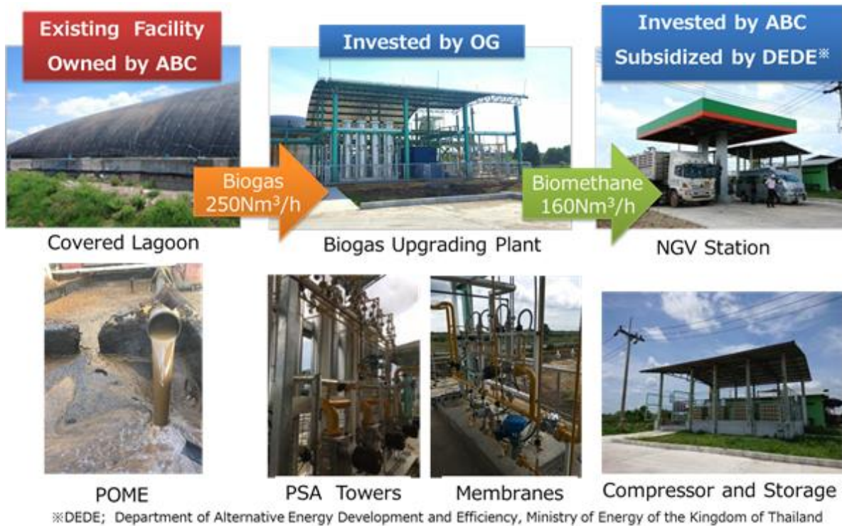
図 3.6 大阪ガスタイランドにおけるバイオガス精製事業の概要
