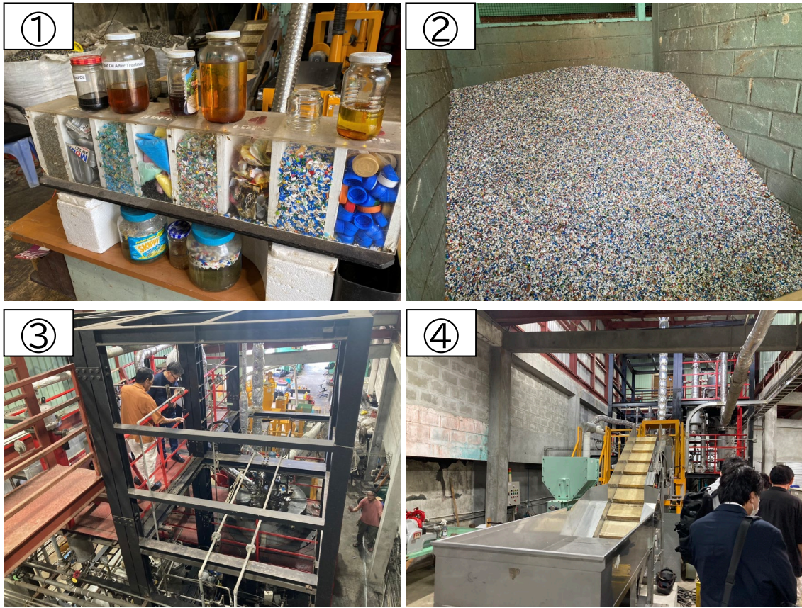
図 3-4：油化原料となるプラスチックと精製された燃料(①)、 分別・チップ化されたプラスチック(②)、油化設備(③・④)
