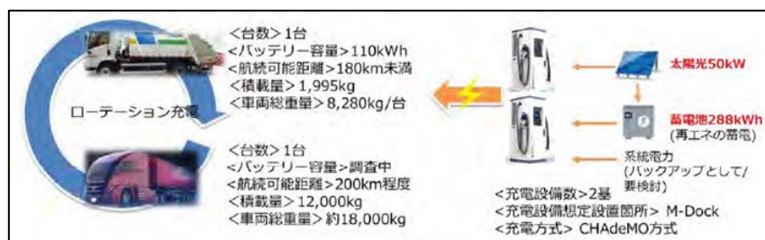
図 2-26 廃棄物収集運搬車両及び充電システム
