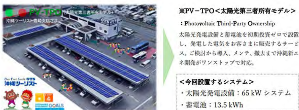
図 7 レンタカーステーションへの PV-TPO 事業事例
