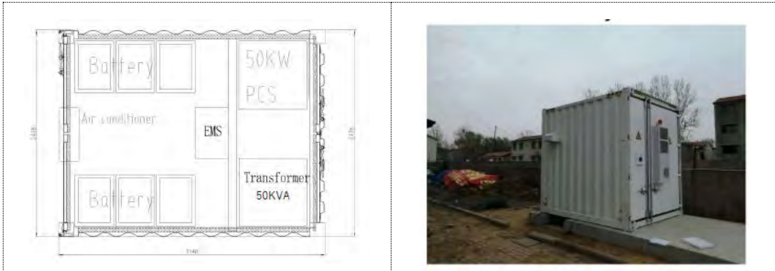
図 2-7 : バッテリーコンテナユニット
