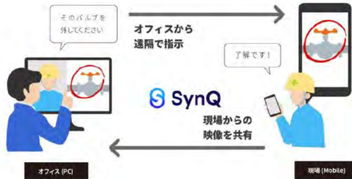
図 2-14：リモートメンテナンスツールの概念図
