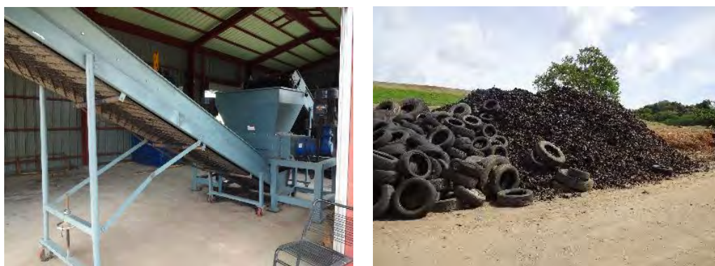
図 4-1 : M-DOCK 旧最終処分場敷地内にあるコロール州の廃タイヤ処理施設。シュレッダーとベルトコンベアー(左)、廃タイヤ及び破碎済みのタイヤ・チップ(右)
