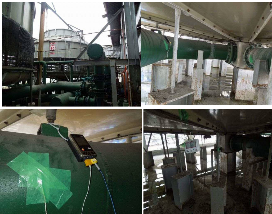
図 21 冷却塔出入口温度・周囲温度・相対湿度計測
