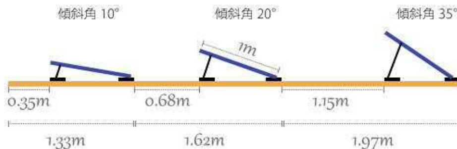
図 11 高さ 1m のソーラーパネルに対する設置角度と設置間隔の関係
