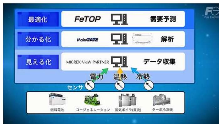
図 3-4 エネルギーマネジメント：「見える化」「分かる化」「最適化」のステップ
