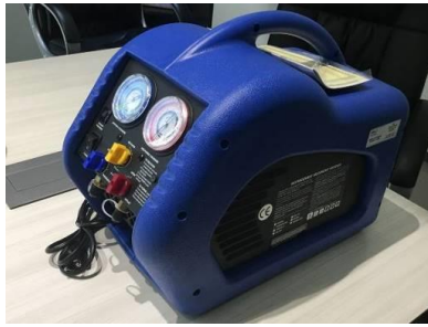
フロン回収装置
