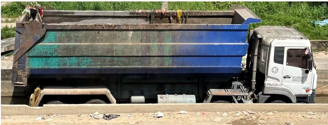
写真 4-3 場内搬送用車両 10t 車 (積載量は推定)
