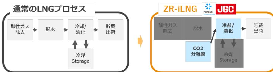
図 3-9 ZR-iLNG プロセスと通常の LNG 液化プロセスの比較
