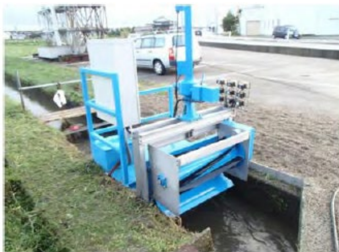
図 4-16 水機工業株式会社がインドネシア国において提案していた水車
