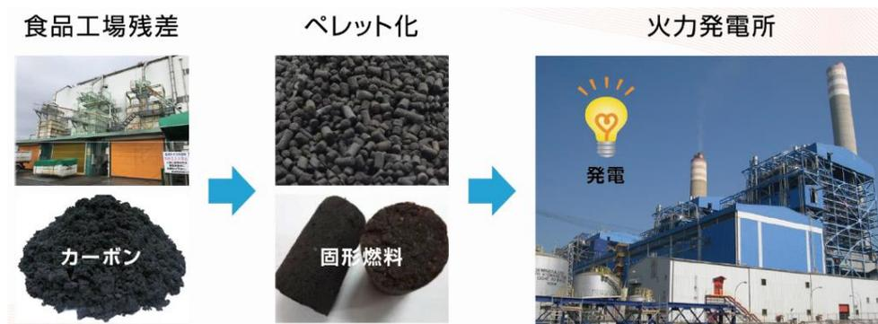
図 3-11 コーヒーかすからの固形燃料化
