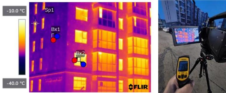
図 4-17 サーモグラフィ撮影による熱損失の確認状況
