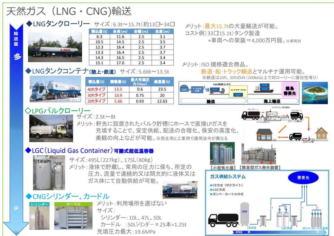
図 3-34 LNG と CNG の輸送量比較
