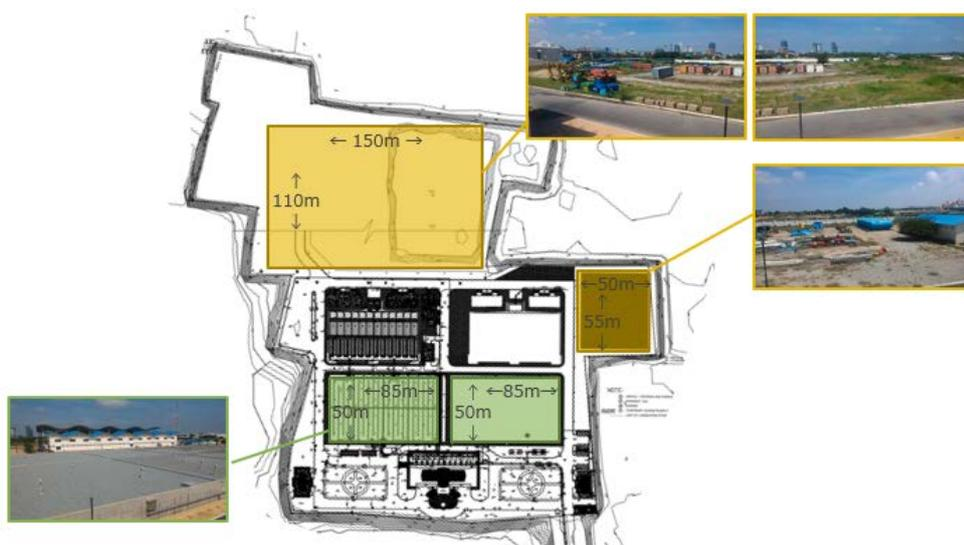
図表 3.3.2-21 Niroth 浄水場のパネル設置候補エリア
