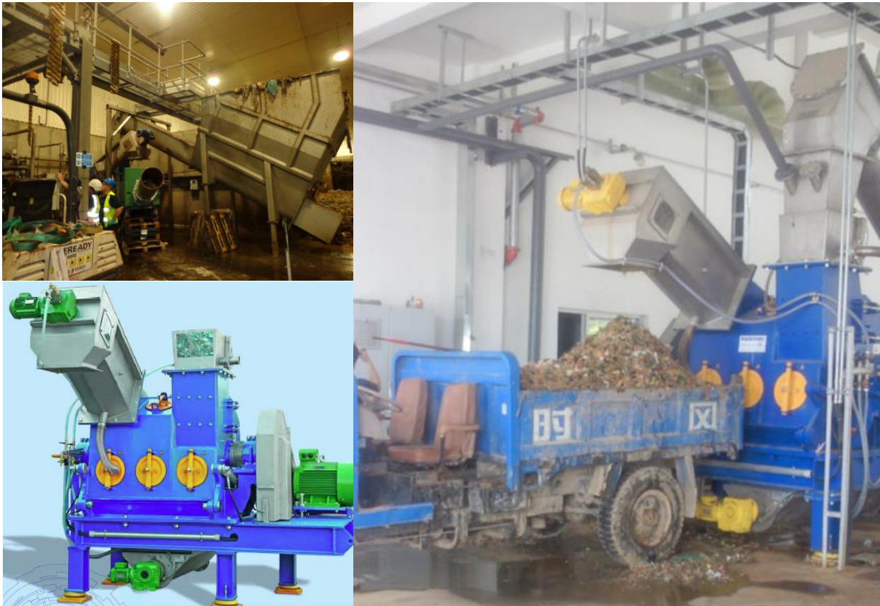
図 2-6-15 ハンマーミルによる破碎・選別例
