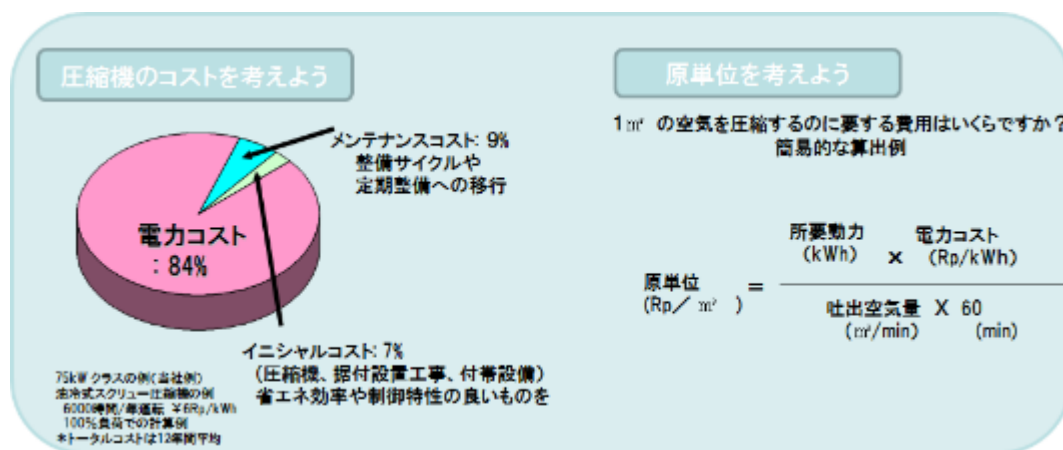
図 2-4 圧縮空気システムのコストの考え方
