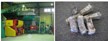
図 4-1 RPF 製造装置（左）と RPF（右）
