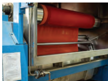
▲染色工場の糊抜き装置 (2025年12月)
