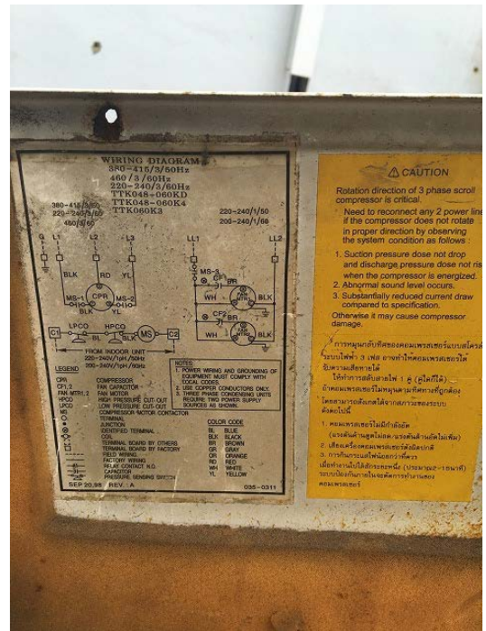
図 7.8 室外機のワイヤリングダイアグラム
