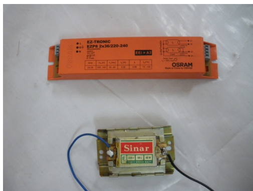
写真 6 銅鉄安定器（下）と電子安定器（上）
