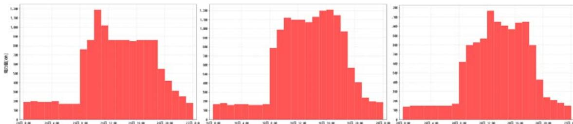
図 5.4-16 BMKG メインビルディングの使用電力量（平日）
