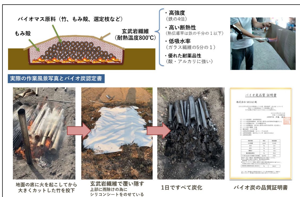
図 4-10 バイオ炭製造技術の概要
