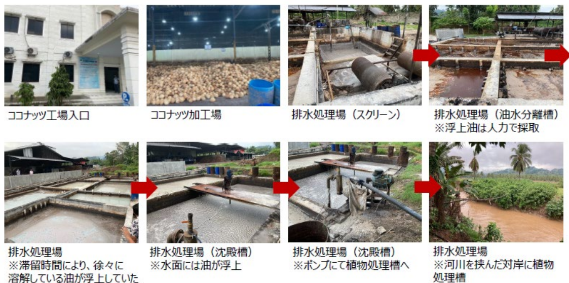
図 3-6 PT. Royal Coconuts における排水処理フロー ((株)愛研化工機作成)
