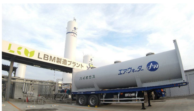
図 3-30 エア・ウォーターのバイオガス輸送車
