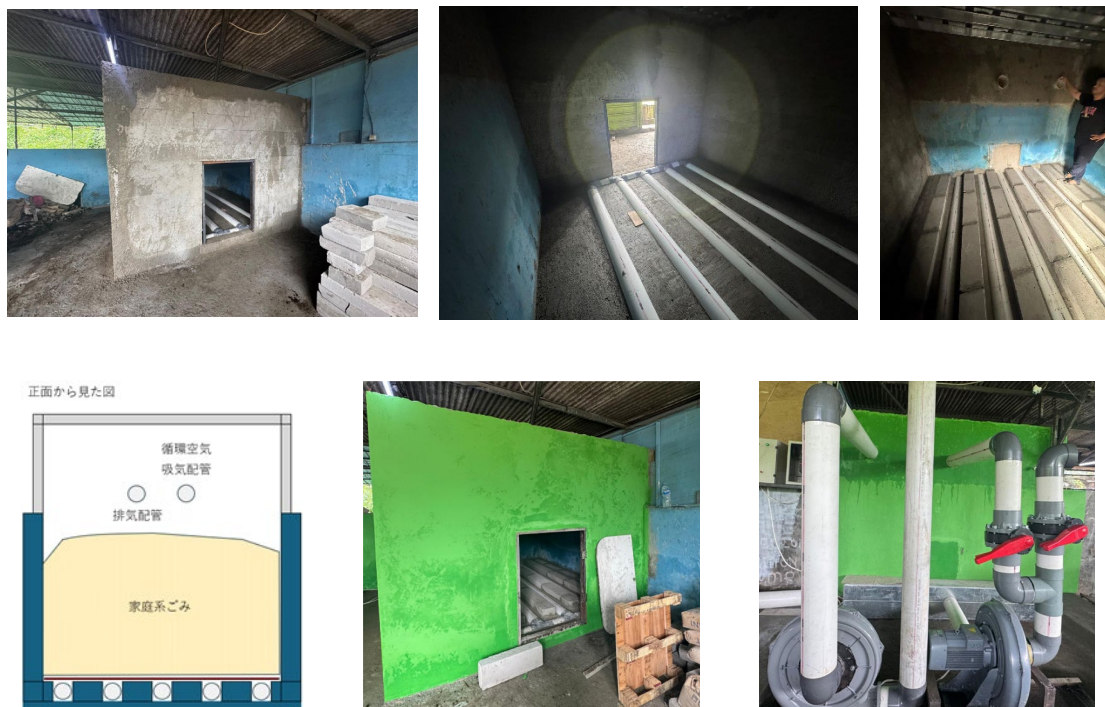
図 3.3.7.1. 生物乾燥の実証試験設備。コンクリート製の発酵槽（左上）、発酵槽底面の通気配管（中・右上）、システム断面概念図（左下）、完成した発酵槽の外観（中下）、ブローアと配管（右下）（出所：調査団が撮影）
