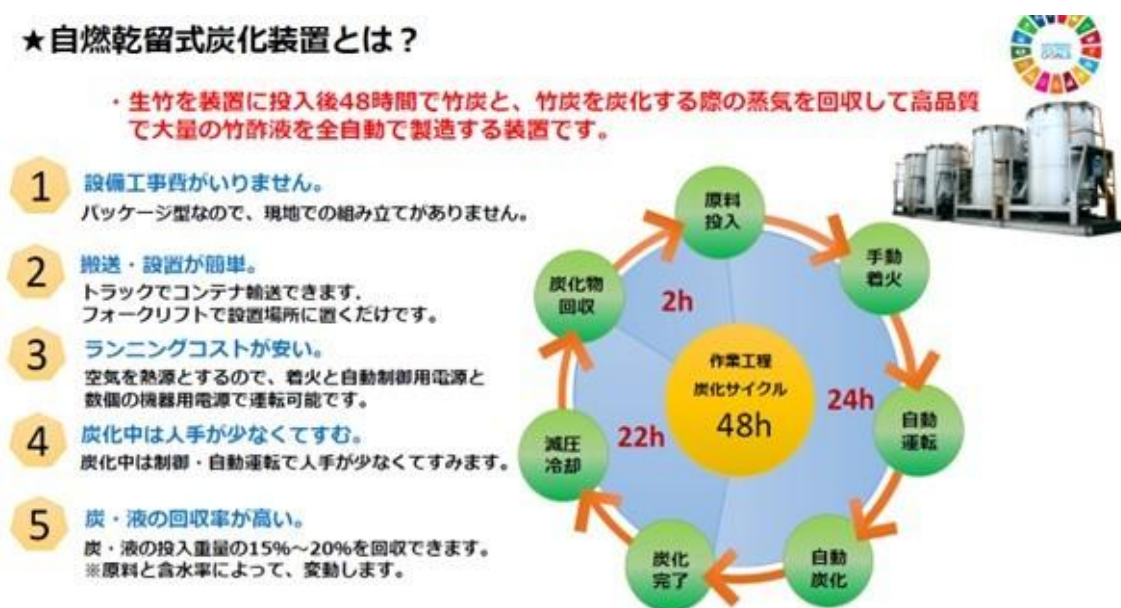
図 3-5 自燃乾留式炭化装置TME-5000型の概要 (出典) マモル電工合資会社提供データ
