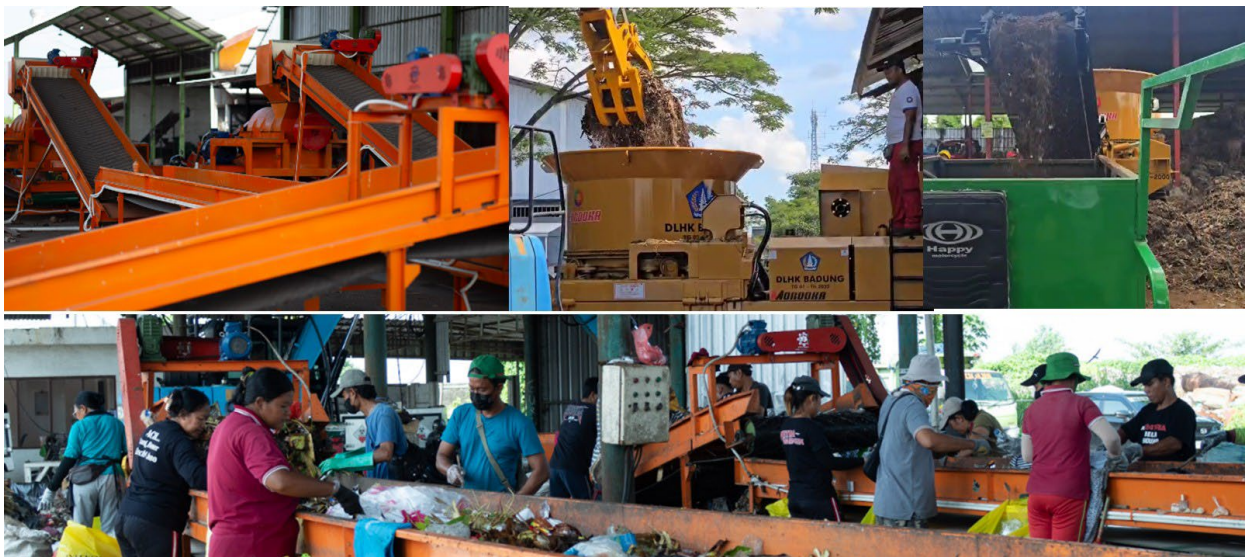
図 3-9 導入した破砕機と搬送設備・分別作業
