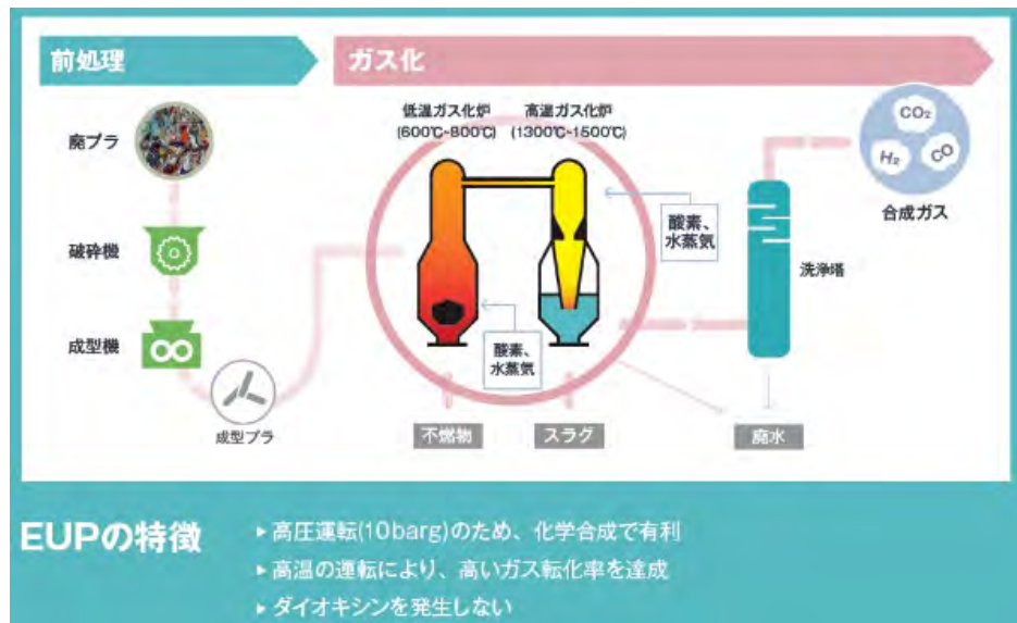
図 3-7 日揮ホールディングスの熱分解ガス化プラントの概要
