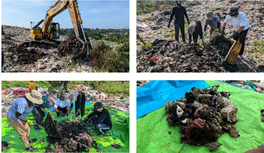
図 2.2.1.3.7. 南タンゲラン市の TPA Cipeucang における掘り起こしごみの組成調査の様子：パワーシャベルによるごみの掘削（左上）、サンプリング（右上）、分類カテゴリーへの分別作業（左下）、20 分類への分別後：軟質プラ（右下）（出所：調査団提供）
