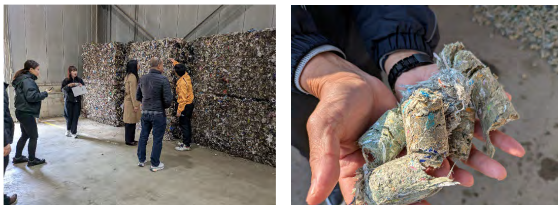
図 2.5.1.1.3. バイオマス資源化センターみとよにおける RDF ベール（左）および株式会社パブリックにおける RDF ブリケット（右）
