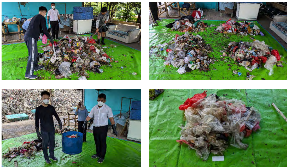
図 2.2.1.3.5. 南タンゲラン市の TPA Cipeucang におけるフレッシュごみの組成調査の様子：四分法による分割前の攪拌（左上）、最初の四等分割後（右上）、1/4 検体の密度測定（左下）、20 分類への分別後：軟質プラ（右下）（出所：調査団提供）
