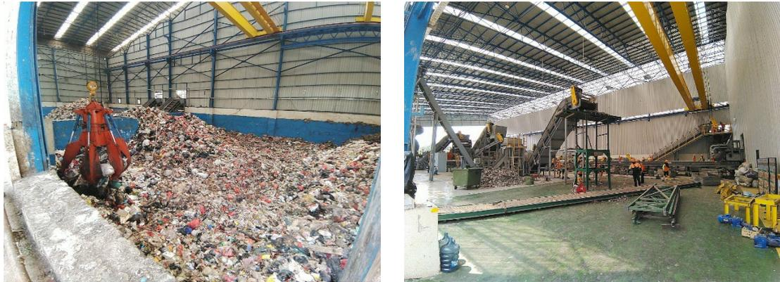
図 2.3.1.3.5 TPST Bantar Gebang の RDF 施設におけるフレッシュごみの受入・保管ピット（左）と分別ライン（右）（出所：調査団が撮影）
