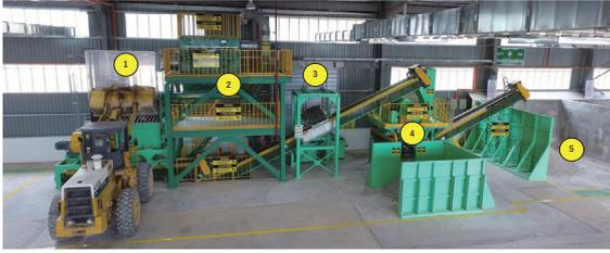
(1) Blender ⇒ (2) Dust Collector ⇒ (3) Magnetic Separator ⇒ (4) Vibrating Screen ⇒ (5) Product
