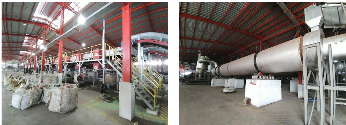
図 2.3.1.3.6 Kesiman Kertalangu TPST の RDF 生産設備における分別ライン（左）とロータリーキルン乾燥機（右）（出所：調査団が撮影）
