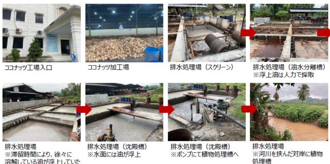
図 3-24 現在の PT. Royal COCONUT における排水処理フロー（株式会社愛研化工機作成）
