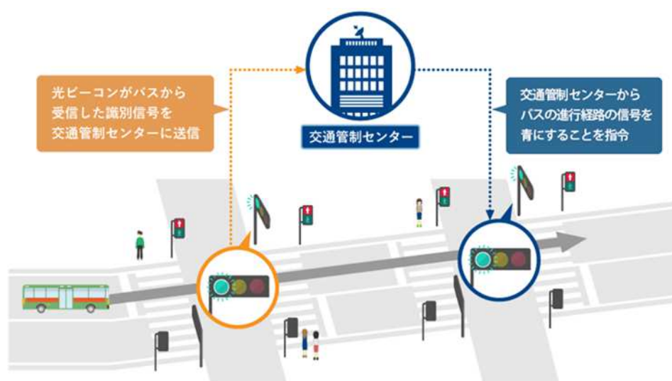
図 5-8 公共車両優先システム (PTPS) の仕組み
