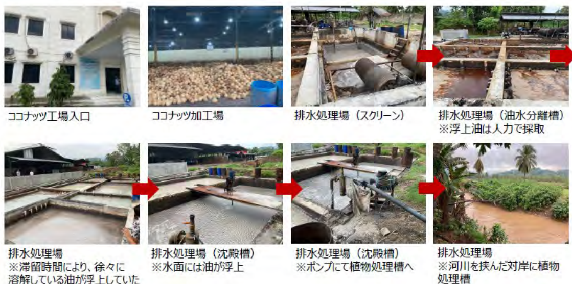
図 3-19 現在の PT. Royal COCONUT における排水処理フロー（株式会社愛研化工機作成）
