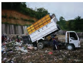
▲TPAへ廃棄する様子 毎日土をかぶせる“sanitary landfill”を実施
