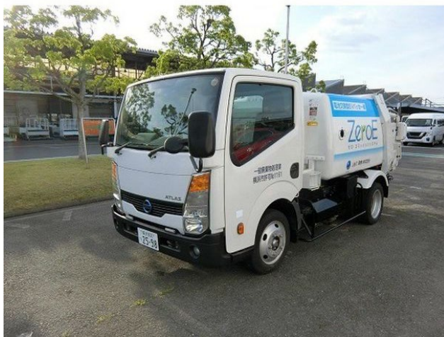
図 3-11 電池交換型 EV パッカー車
