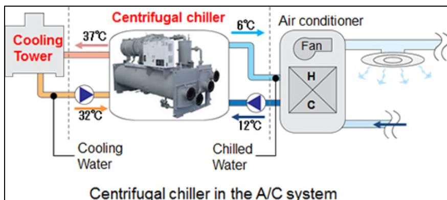
図 水冷ターボ式冷凍機のイメージ
