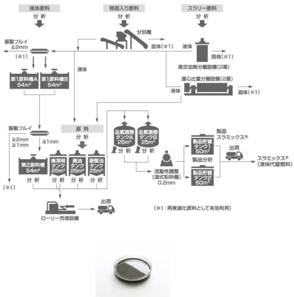
図 3-4 液体代替燃料「スラミックス®」の製造工程、及び製品イメージ
