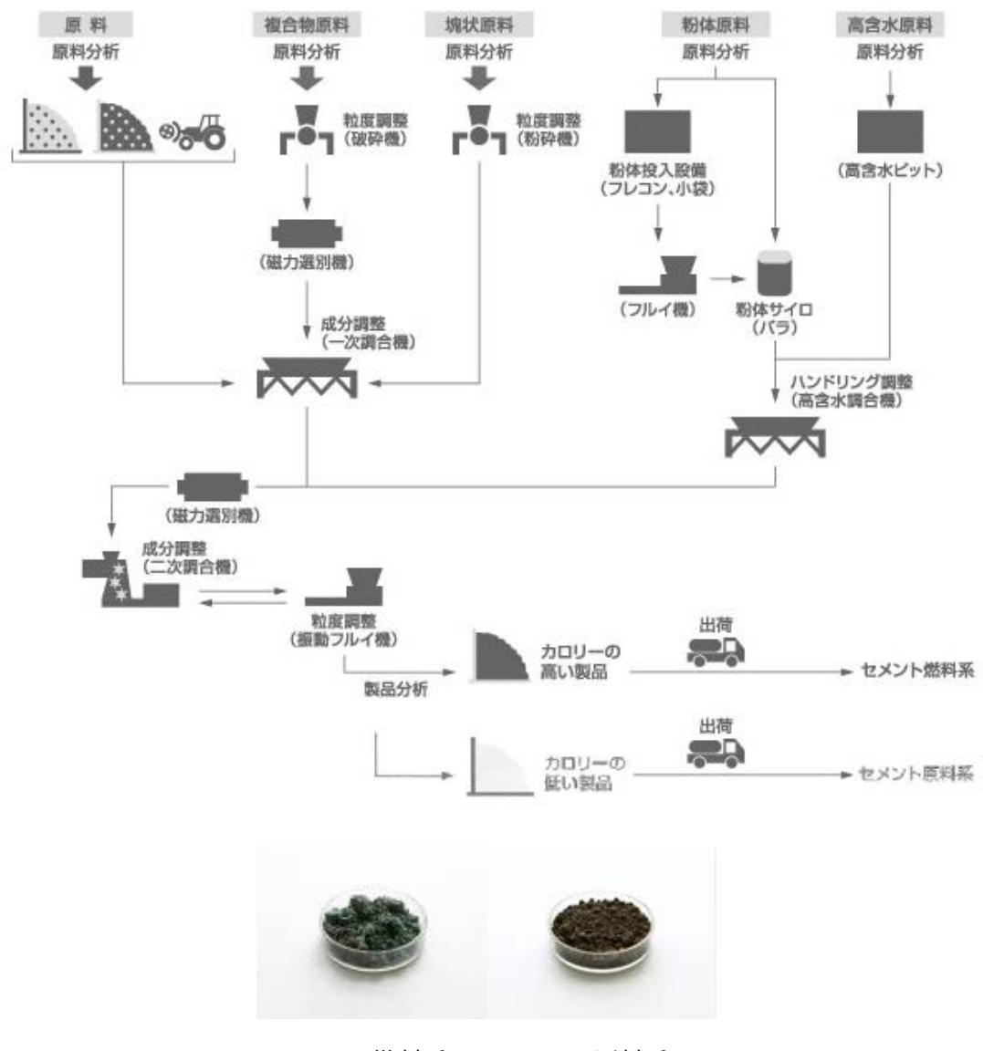
図 3-5 セメント原燃料「CRM(Cement Raw Material)」の製造工程、及び製品イメージ
