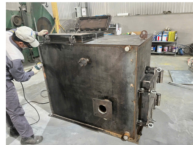
バイオマス温水ボイラの試作機
