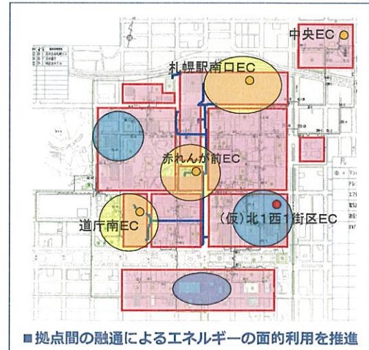
分散型エネルギー供給拠点の設置による都心部全体のエネルギーネットワーク構築をめざしています
