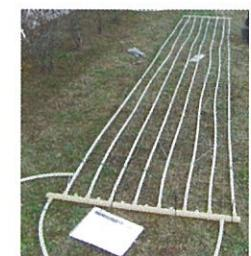
樹脂製柵状熱交換器の概要と外観
