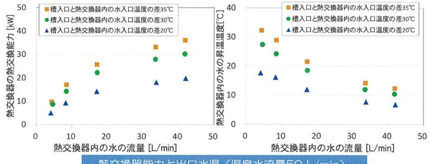
給湯用の井水を排湯槽内に導入した熱交換器を通して直接、または間接的に予熱する、省エネルギー性、経済性に優れた給湯予熱システムを開発しました。
