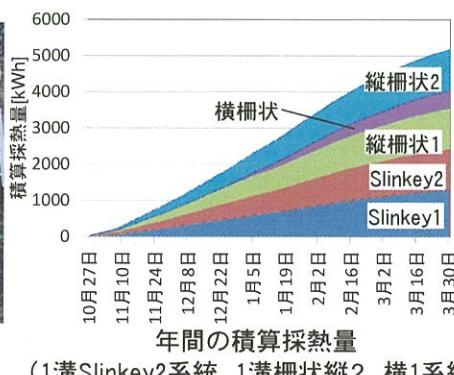
他の採熱方式との省エネルギー性、経済性の比較(当別町、2溝6系統10m)
