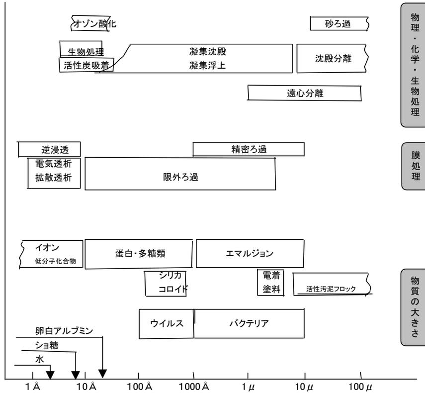
図 1-7-1 廃水処理における汚染物質の大きさと処理方式
