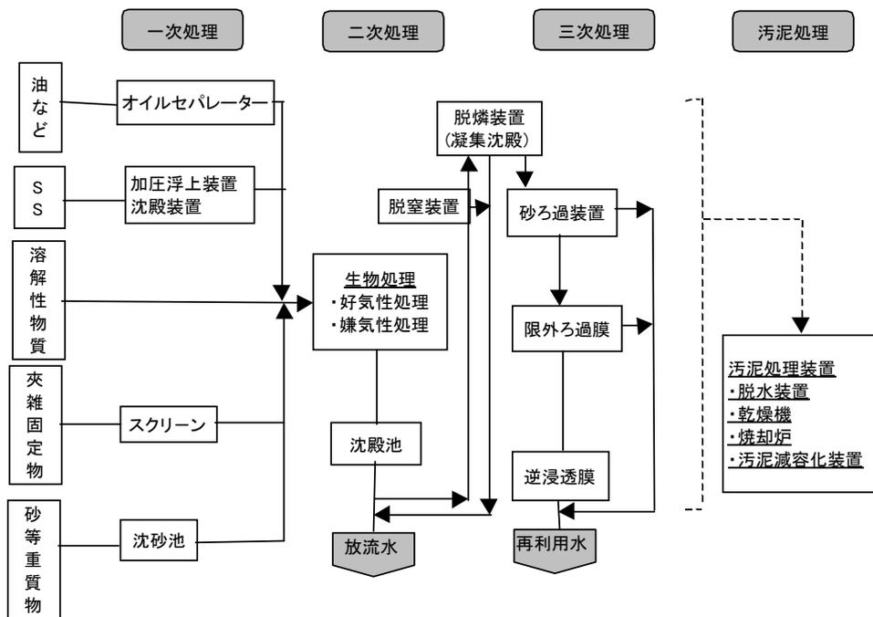
図 1-7-2 廃水性状と処理方式の概念
